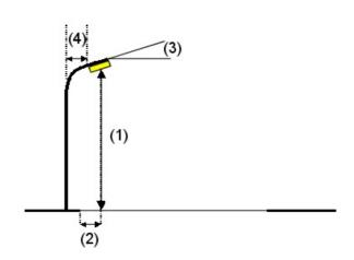
Lampada: PHILIPS BPP794 MK-BK FG T25 1 xLED64-4S/830 DS50 Flusso luminoso (Lampada): 4288 Im Valori massimi dell'intensità luminosa
